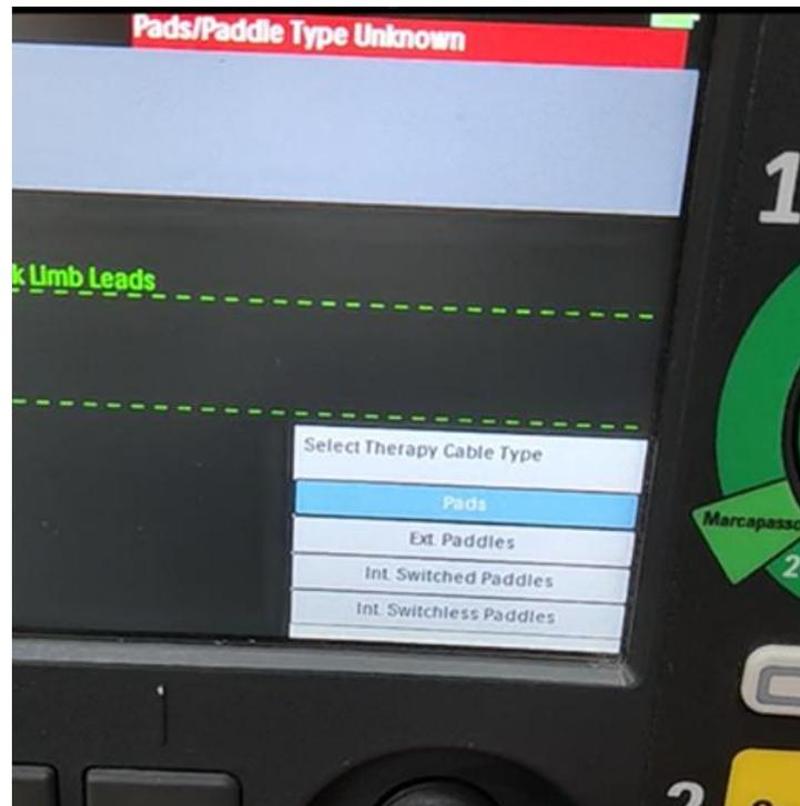
Figura 1: La pantalla del DFM100 con el problema de identificación incorrecta de las palas.
