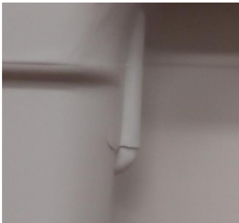
Ejemplo de una grieta en la bandeja de embalaje Intellipack
