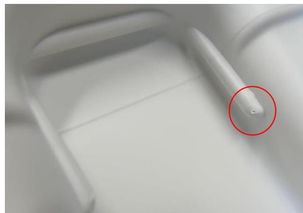
Ejemplo de una grieta en la bandeja de embalaje Intellipack
