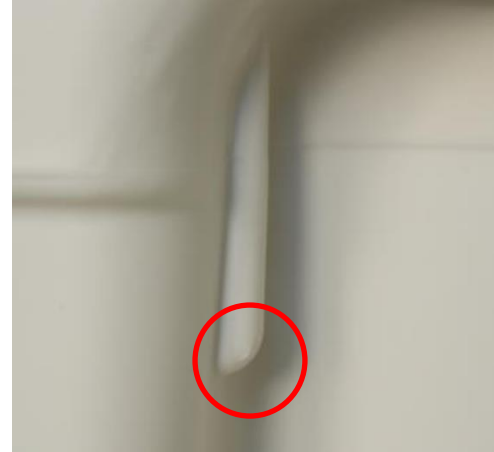
Marcas de tensión blancas en la bandeja de embalaje Intellipack
