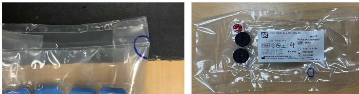
Figura 1: Fotos de pequeñas fugas identificadas en la barrera estéril (marcadas con un círculo)
