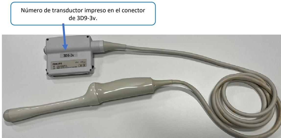
Figura 3. Identificador de dispositivo y número de serie impresos en el conector.
