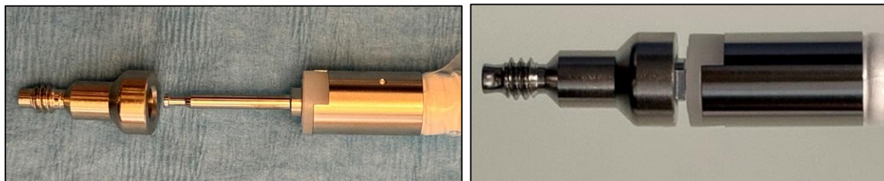
Figura 2. Separación del GDS deslizante y hueco importante
