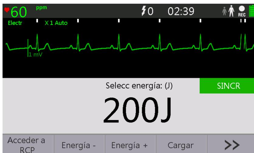
Puede monitorizar el ECG con los electrodos multifunción o con electrodos conectados a un cable de ECG de 3 derivaciones. La descarga se administra a través de los electrodos.
