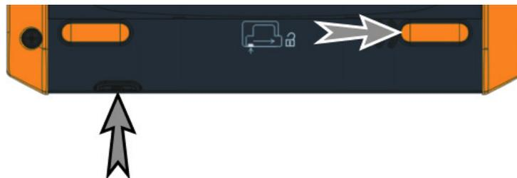
2. Apriete el seguro de la batería con fuerza, desplace la batería hacia la derecha y levántela como se indica a continuación:
