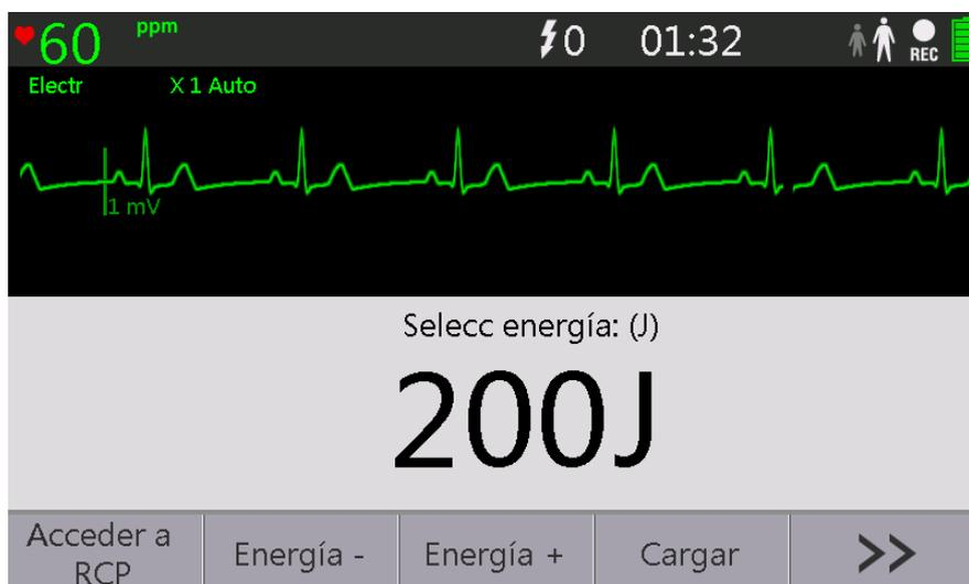
En este modo se muestra una onda ECG y los parámetros relacionados. En el centro de la pantalla se muestran el icono Sincrónico, los mensajes de aviso, la energía seleccionada y un contador de descargas.
