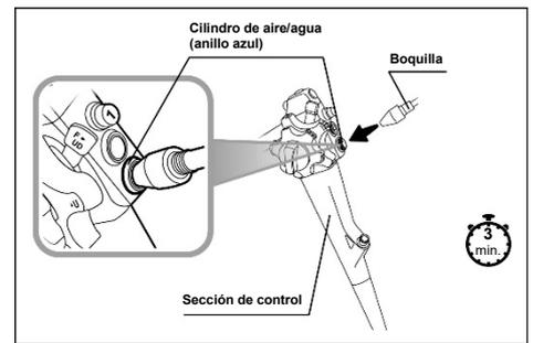
6. (3er puerto) Sujete el conector del endoscopio, y airee la entrada auxiliar de agua, como se indica a continuación:
