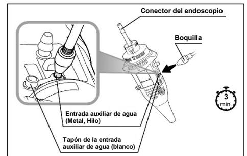
7. (4º puerto) Sujete la sección de control, y airee el puerto del canal de trabajo, de la siguiente manera:
