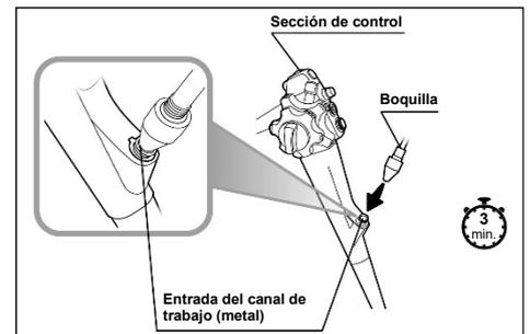
8. Seque por completo el interior del cilindro de aspiración, el cilindro de aire/agua, y la entrada del canal de trabajo del endoscopio con gasas de algodón estériles.
