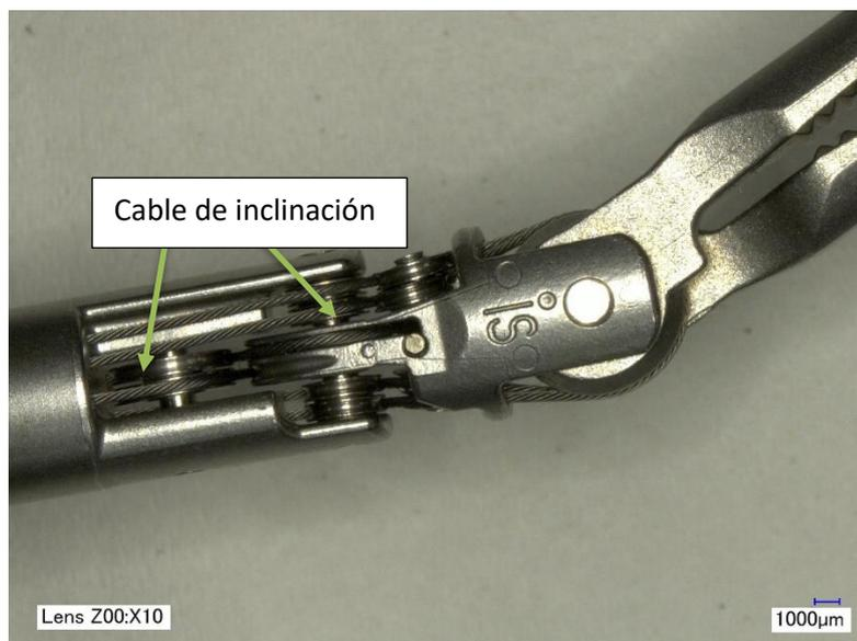
Figura B: Ejemplo ampliado 10x de un cable de inclinación intacto en un instrumento Small Graptor de da Vinci Xi.
