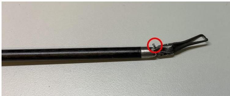
Figura F: Cable de inclinación roto.
