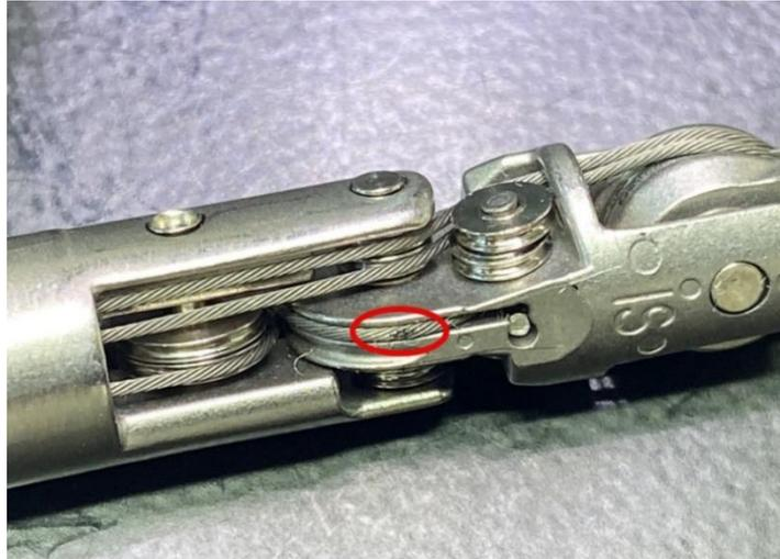
Figura G: Cable de inclinación pelado.
