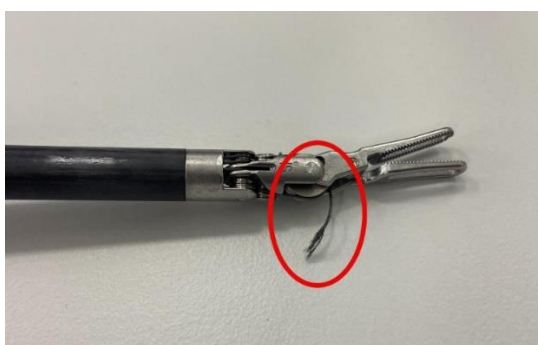
Figura H: Cable roto.
