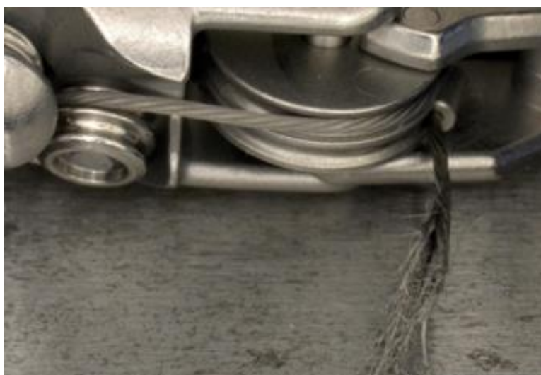
Figura C: Aumento de 20x de un cable de agarre roto en un instrumento da Vinci Xi.
