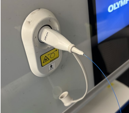
Imagen 3: Fibra sin daños
