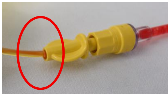
Figura 1: Ubicación de la fuga
